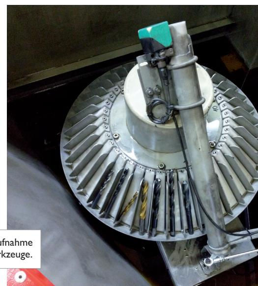
Das Entladesystem mit Fächeraufnahme für fertig bearbeitete Bohrwerkzeuge.
