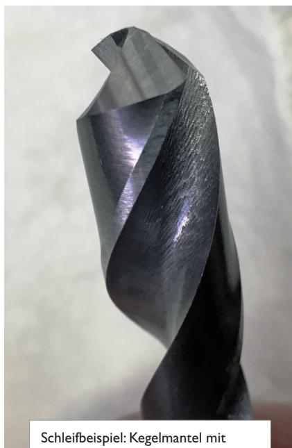
Schleifebeispiel: Kegelmantel mit radialem Hinterschliff.
