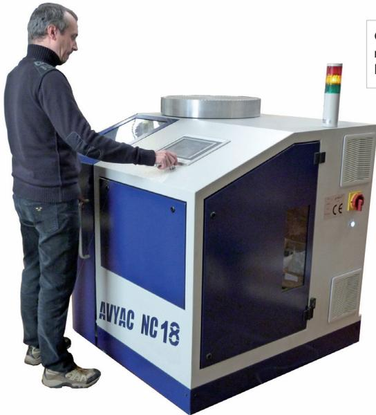
CNC-Bohrer-Schleifzentrum NC 18 mit dem links oben angeordneten Rundmagazin für bis zu 90 Bohrer.
