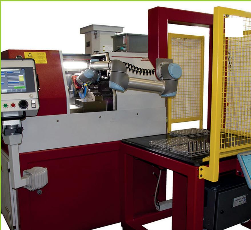
Rundschleifmaschine / Schälenschleifmaschine für HSS,
